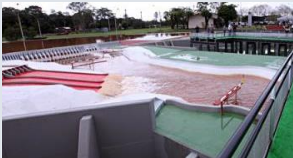
Figura 6 Modelo Reduzido da Usina de Itaipu ( http://goo.gl/h75chK )
