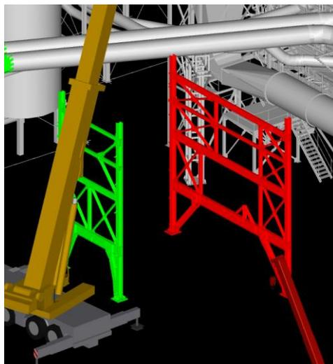
Figura 36 – Visualizando das atividades atrasadas/adiantadas no Autodesk Navisworks Manage 2014
