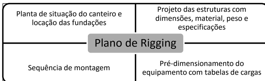
Figura 12 – Informações requeridas para elaboração do plano de *rigging* segundo Pinho (2005)
